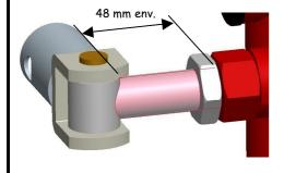
2. Monter la butée avec les colliers simples ou doubles puis le battant de porte avec les colliers 90°. Ajuster les gonds si nécessaire.
