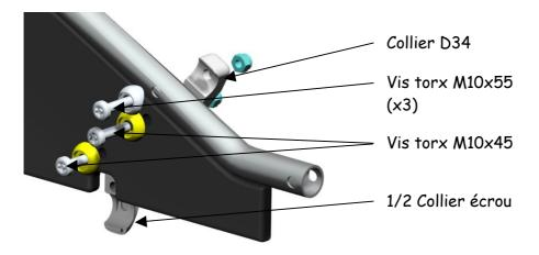
3. Assembler enfin le panneau décor sur le panneau métallique correspondant avec 2 colliers 89 simples ou doubles fixés aux extrémités du tube cintré. Monter les 1/2 colliers hpl vis et vis torx M10x55 et les écrous nylstop restants (4x).
