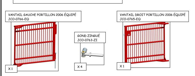
1. Visser les gonds dans chaque vantail. La tige filetée doit dépasser d'environ 48 mm de l'écrou soudé.
