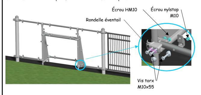
4. Monter les panneaux HPL/HDPE avec les vis torx M10x30 et les écrous nylsop.
