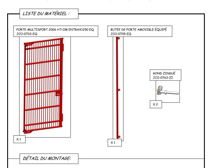
1. Visser les gonds dans chaque vantail. La tige filetée doit dépasser d'environ 48 mm de l'écrou soudé.
