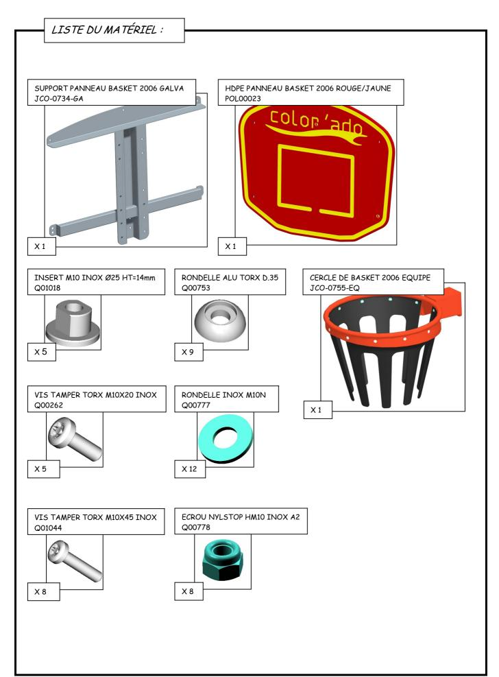
1. Monter le panneau sur son support avec les inserts insert m10 inox, les rondelles alu torx D35 et les vis torx M10x20 (5x).
