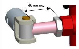
2. Monter les deux vantaux avec les colliers 90° JPI-0083-KI. Ajuster les gonds si nécessaire. Le locquet se manipule <u>côté extérieur</u> du terrain (côté ouverture). Prévoir un plot béton 150x200
